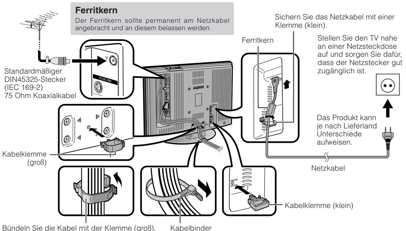
Bündeln Sie die Kabel mit der Klemme (groß). Kabelbinder
